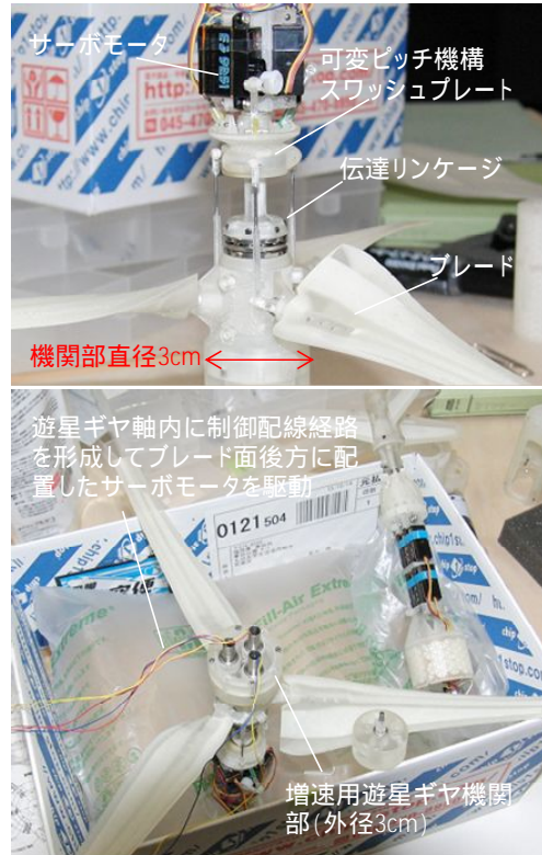
図8: 小型模型専用に設計され3Dプリント部品で構成された風車主要機関部
