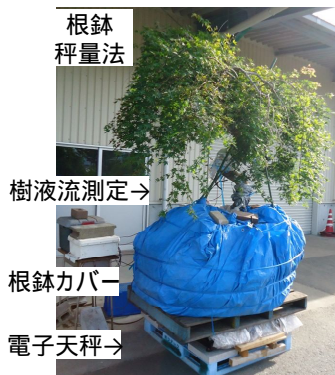
写真-1 根鉢秤量法(測定状況)
