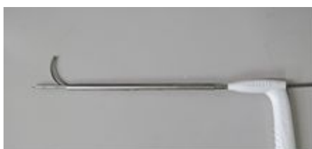
図4 ステンレス同軸針(外径5.0mm/内径4.0mm)の中に2.4mm凍結端子とニチノール・銅(外径1.2mm)の側枝2本を挿入
