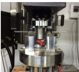
図5 オートグラフ（島津製作所）で測定
