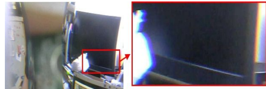
図6 試作したマルチスペクトル画像センサで撮影した画像例。左画像の赤枠内を拡大した画像を右に示す。虹状のスペクトルが観測された。
