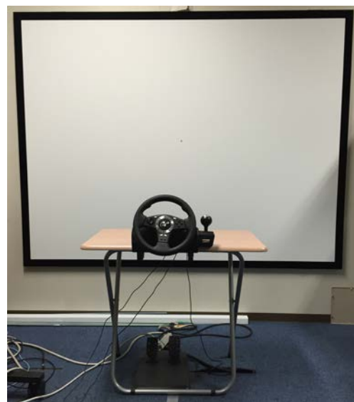
図2 簡易型ドライビングシミュレータ
