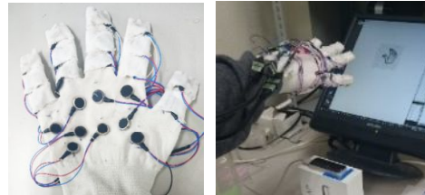
図 3 複数の振動子を用いた手指への多点代替力覚提示デバイス
