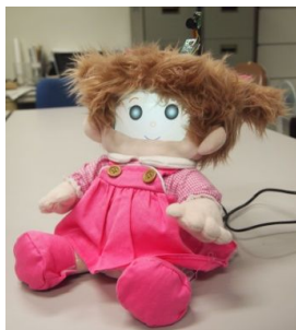
図5 タブレット PC で顔を構成したロボット
