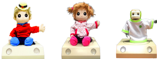
図6 頭部、腕部、全体の回転の運動ができるロボット
