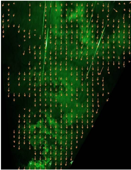
図3 . PIV による風速ベクトルの例 0.1 秒間隔で撮影された 2 枚の画像 ( 図 2 ) から算出された結果。
