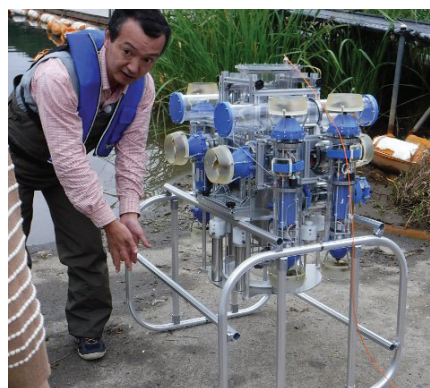
図5 採泥モジュールを取り付けた水中ロボット（作業台に搭載している状態）
