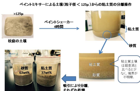
図6 超音波照射による沈降によるサンプル汚染土壌の砂質成分と粘土質成分の分離の様子
