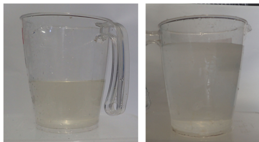
写真3 エアレーション前後の処理溶液の色変化(左:エアレーション前、右:後)
