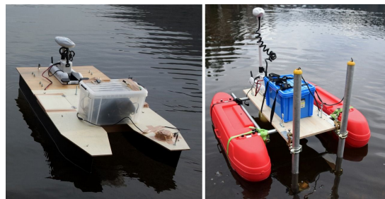
図1 開発した遠隔調査船、左が安定性を重視した船艇、右が可搬性を重視した分解可能な船艇、長さはそれぞれ1.2mである。
