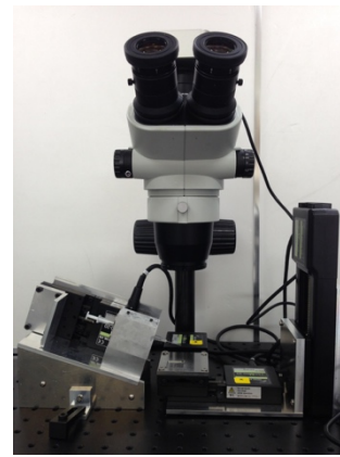
図1. 多層ゲルビーズスポットニング装置
