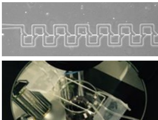
図 2. 作製した細胞捕捉用マイクロ流路
