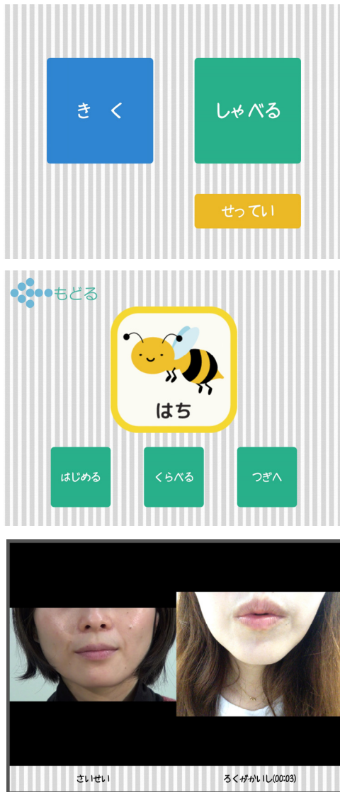
図3 開発した発話訓練装置の画面例. (上):聴取訓練, 発話訓練の両者が可能. (中):イラストに対応した音声が出力される. また, 使用者自身の発話と聞き比べることができる. (下):自身と健常者の発話時の口唇の動きを動画で比較可能.
