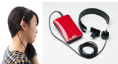
図 1 申請者らが開発した骨導超音波補聴器(BCUHA-007)。音声や環境音によって約 30 kHz の超音波が振幅変調され、振動子によって片側の乳様突起に呈示される。
