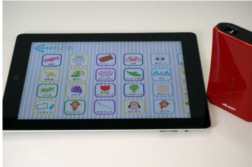
図2 開発した発話訓練装置. 骨導超音波補聴器と無線接続して使用する.
