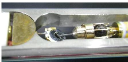
図8 TEM 用試料表面に近接させた銀微粒子を担持した金属探針。
