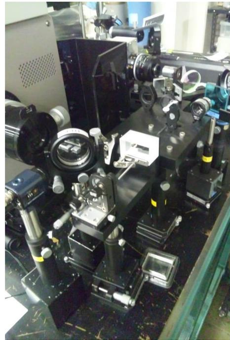
図3. 裏面計測用速度干渉計 VISAR
