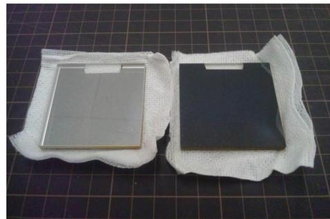
図4. 作成した試料ガラス側（左）試料側（右）。これを合わせて、試料を中心にしたサンドイッチ型のターゲットを作成。
