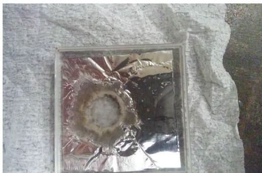
図5. レーザー照射を受けた、閉じ込め型試料。レーザースポットは直径0.5mmである。
