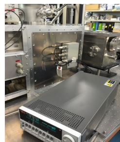
Fig.1 : 開発した CNT-QD 冷却性能評価システム。従来の冷却受信機/分光計測システムに超低雑音電流電圧システムや温度可変の冷却黒体チャンバーを実装している。
