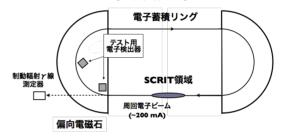
SCRIT で捕獲された標的核を励起し超前方 (~0度)に散乱されたエネルギーの下がった電子を、偏向電磁石内での検出することで、捕獲標的核による光吸収事象同定を試みる。超前方への電子散乱断面積は、仮想光子理論を適用することで、 線吸収断面積に焼き直すことができる。
