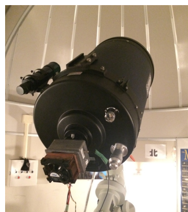
図 9 山形大学天文台に搭載したパルサー時刻計測システム
