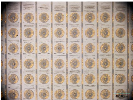
図7: 試作した炭素スパッタによる \mu -PICの表面の写真。各ピクセルは縦横とも400 \mu mピッチに並んでいる。
