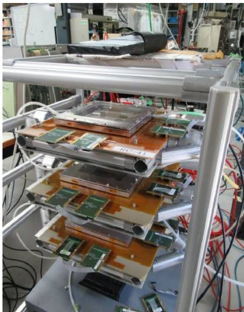
図12： 試作機3台を並べた、 \mu 粒子測定セットアップの写真。
