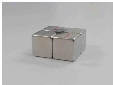
図1 4個のネオジウム磁石の上で安定して浮上する熱分解カーボン。
