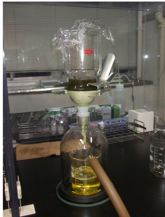
図 1. CAS 回収に用いた吸引ろ過装置
