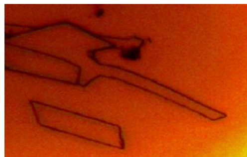
図2 金(111)表面に生成したリチウム内包フラレン薄膜結晶の光学顕微鏡写真
