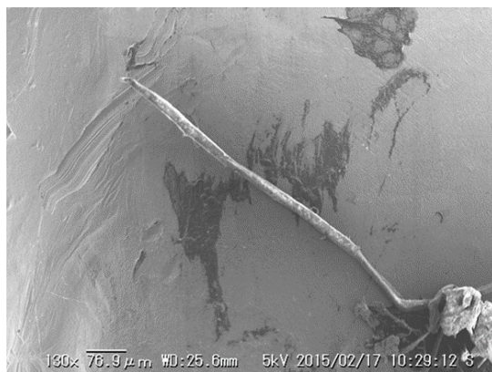
図7 Sn (5wt%Ru) における表面欠陥の生成
