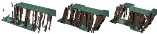
図 9. 凹凸磁極を用いたせん断試験(左から平板磁極、浅い凹凸磁極(溝深さ 5 μm)、深い凹凸磁極(溝深さ 15 μm))
