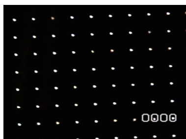
図8 試作した円筒電極アレイ マイクロモデル
