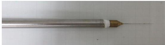
図3 圧力計測プローブ
