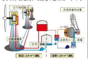
ティーに移送して蓄熱し、必要時に発電する。回転エネルギーは理論上 100%電力エネルギーに変換できるのに対してカルノー効率に制限され 40%としかならない熱機械を通す、というこの点だけを見ると全く非合理的であり、社会的にも学術的にも全く認知されていない技術であった。
