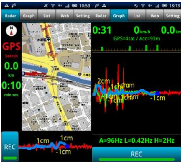
図-1 Bump Recorder AppにおけるIRI計測画面 (バンプレコーダー株式会社HPより)
