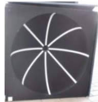
図9 配光測定装置内部
