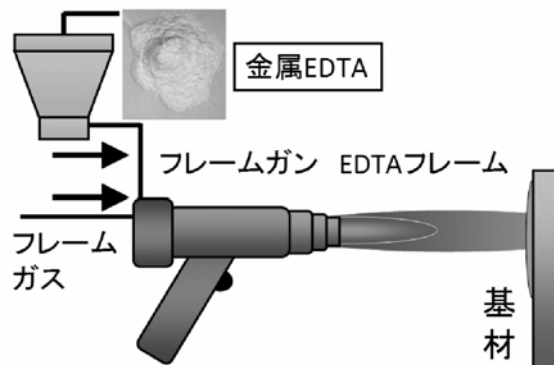
図 1 EDTA フレーム堆積法の原理。金属 EDTA をフレームガスに投入し、フレーム中で金属 EDTA を分解すると、基材に金属酸化物が堆積する。右上は Er 2 O 3 厚膜(30 μm)を 50 mm x 100 mm 基材上に均一にコートした試料。
