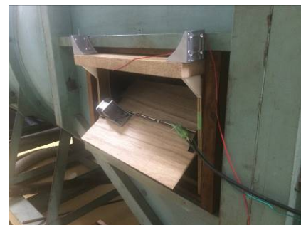
図 10 風洞壁面の回転扉（回転途中の様子）
