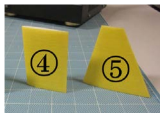
④：アスペクト比が大きい垂直エルロン，⑤：テーパー付き垂直エルロン
