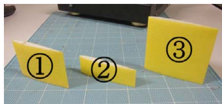
①：基準となる垂直エルロン，②：翼面積が小さい垂直エルロン，③：翼面積が大きい垂直エルロン
