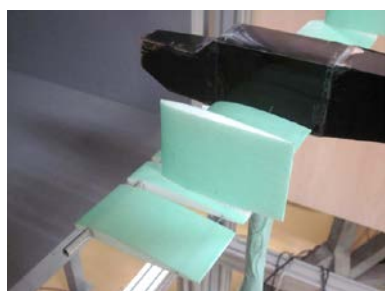
図4 主翼および垂直エルロンを構成するブロック
