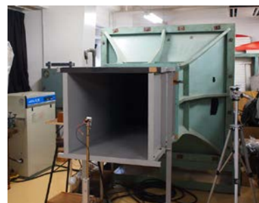
図2 吹き出し式低速風洞
