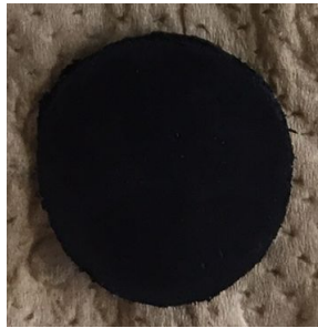
図8 一体型のガス拡散層
