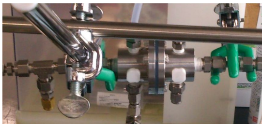
図5 実験に用いた水電解セル
