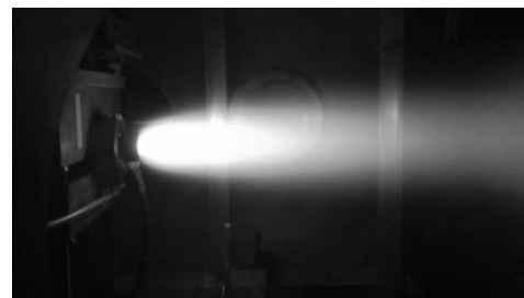
図12 改良型ガスジェネレータを用いた改良型アノード輻射冷却式アークジェットのの水・窒素混合作動
