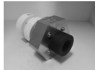
図11 改良型アノード輻射冷却式アークジェットの写真
