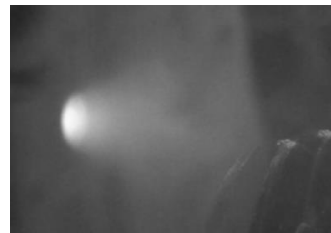
図10 改良型ガスジェネレータを用いたアノード輻射冷却式アークジェットのの水作動
