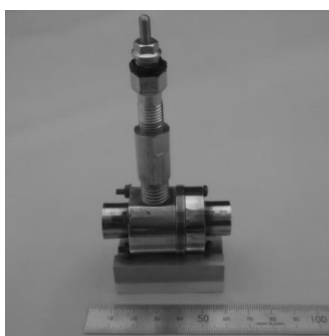
図 3 オリフィス付改良型ガスジェネレータの写真
