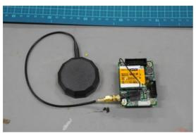
図2 イリジウム衛星通信モジュール
