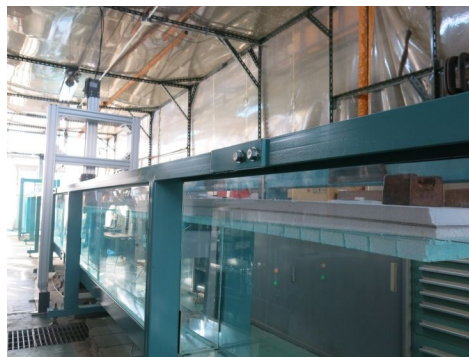
図 5 超大型浮体の縮尺模型
