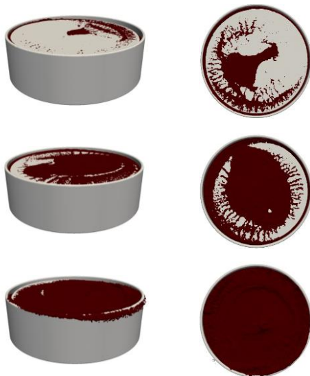
図2 スロッシング発生時の液面動揺と浮き屋根の相互作用シミュレーション
