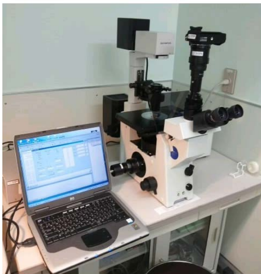
図7 マイクロ流路、顕微鏡、マルチチャンネル分光器からなる蛍光自動分取システム
