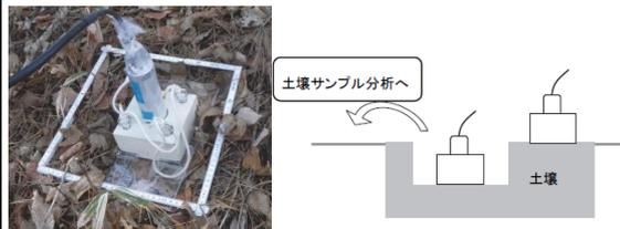
図1 ガンマ線スペクトル測定の様子（左）と土壌サンプリングとガンマ線スペクトル測定の様式図（右）
