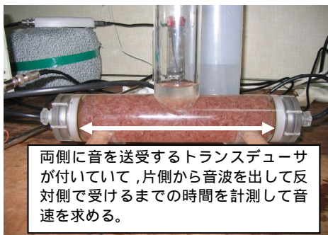
図 3 . 動物プランクトンの体内通過音速の測定法
