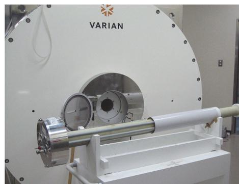
図 1 Agilent 社 7T MR 装置と内径 60mm、100G/cm 高性能傾斜磁場コイル
