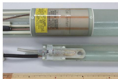
図 2 信号検出のための送信用  $^1\text{H}$ ,  $^{13}\text{C}$  二重同調容積コイル (上) と受信用  $^1\text{H}$  表面コイル
