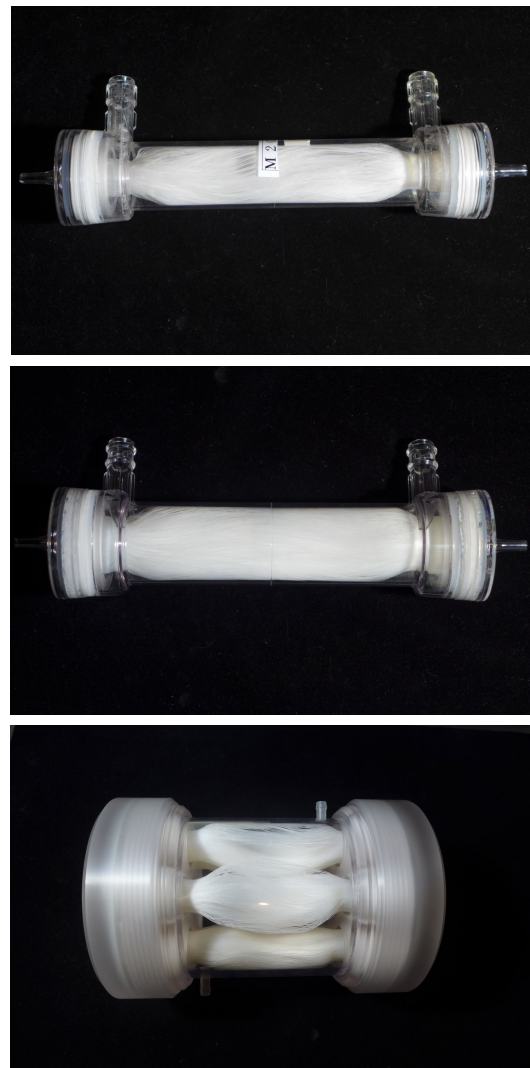
図1 試作人工肺、上から M20-6000、M40-6000、M40-38500
