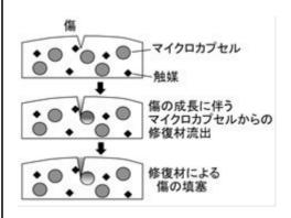
自己修復機能の作用機序 マイクロカプセルが傷と接触することによ り修復材が放出される
