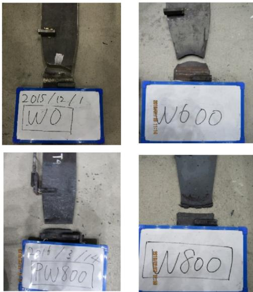
図4 加熱後の試験体写真(左上:FW[RT]、右上:FW[600°C]、左下PW[800°C]、右下:FW[800°C])
