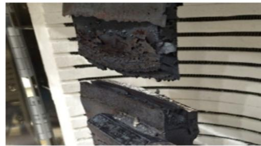
図5 FW[800°C]の溶接部破断写真
