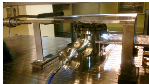
図1 : 本研究で開発した高温電子線照射装置 (量研機構高崎研1号加速器用)。
