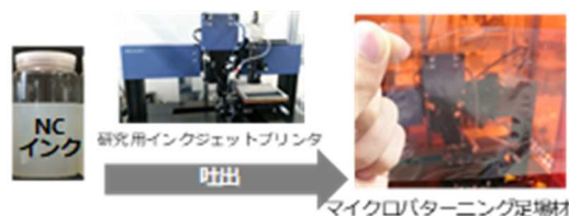
図1 NCインクのインクジェット印刷によるマイクロパターンニング細胞培養足場材の調製スキーム
