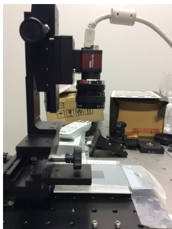
図3：LFディスプレイの校正
