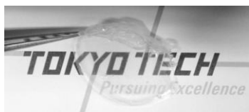
図3. イソマンニド由来ポリエステルのキャストフィルム。
